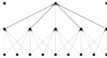
4.32. ábra. A Gauss-piramis kiszámítása (egydimenziós illusztráció)
