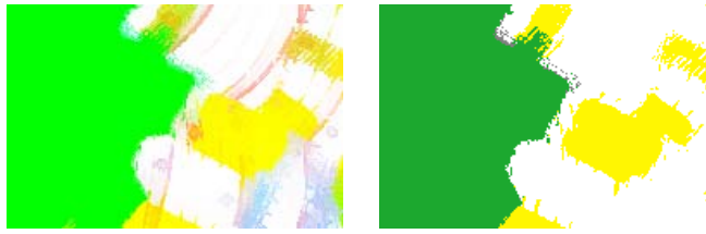
2.9-2.10: A színdetektálásra alapozott szegmentálás kiinduló képe és eredménye.
