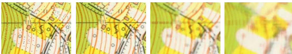
1.17: Az eredeti kép, „só és bors” típusú hibákkal terhelve. 1.18: Konzervatív simítással eltüntetve a hibák. 1.18: 5x5 méretű mediánszűrővel tisztítva a képet. 1.19: 11x11 méretű mediánszűrővel szűrt változat.
