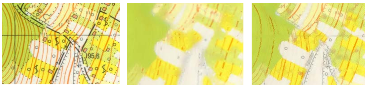
1.69: Eredeti kép. 1.70: Élmegőrző maszkolt mediánszűrővel szűrt változat. 1.60: Sarokmegőrző, adaptív méretű maszkolt mediánszűrővel szűrt változat.
