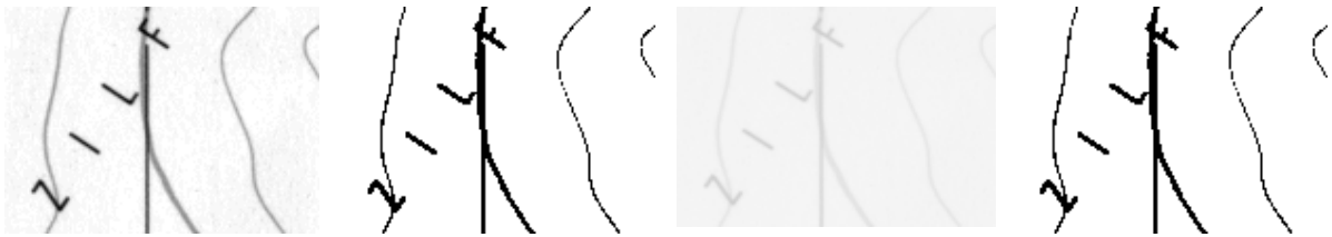
1.28: Eredeti szürkeárnyaltos kép. 1.29: A kép Otsu eljárásával küszöbölt változata. 1.30-31: A kép halványabb változatát az eljárás ugyanolyan jól küszöböli. Egy előre beállított küszöbérték az első képet jól, a másodikat teljesen rosszul küszöbölte volna.
