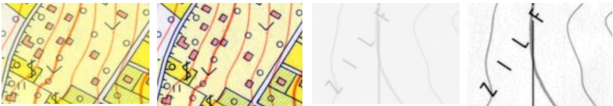
1.24: Eredeti kép. 1.25: A kép hisztogram normalizálás után. 1.26: Kevésbé kontrasztos, szürkeárnyaltos kép. 1.27: A kép hisztogram normalizálás után.
