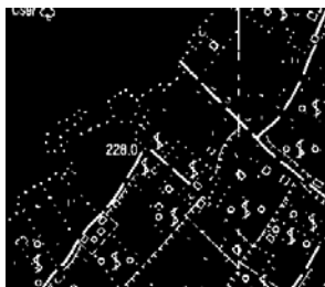
1.65: Az eredeti kép. 1.66-67: Lokális Otsu küszöböléssel detektált feketék és barnák. 1.68: Egyesített maszk
