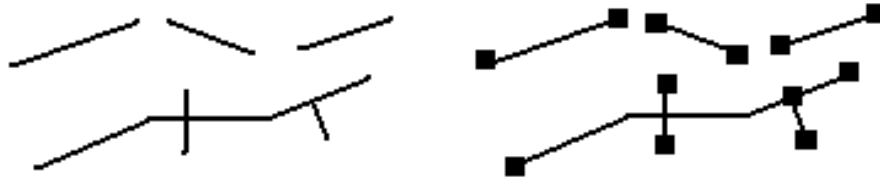
15: A hálózati réteget leíró töröttvonalak. 16: A (13) kép által meghatározott hálózati gráf.
