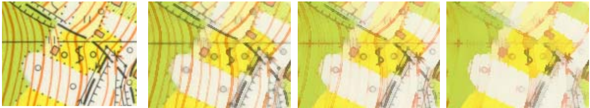
1.54: Eredeti kép. 1.55: Sarokmegőrző box szűrővel szűrt változat. 1.56-57: 7x7 méretű élmegőrző mediánszűrő első és második futtatásának eredménye. Az 57-es kép már elég jó bemenet a nagy területek vektorizálásához.
