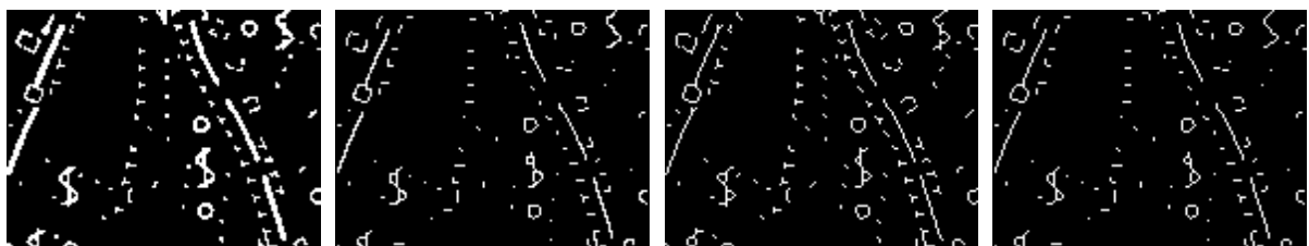
1.40: Az eredeti kép. 1.41: Az első vékonyítási algoritmus eredménye. 1.42: Morfológiai vékonyítás eredménye. 1.43: Morfológiai vékonyítással egyszerűsítve az 1.41 képet.
