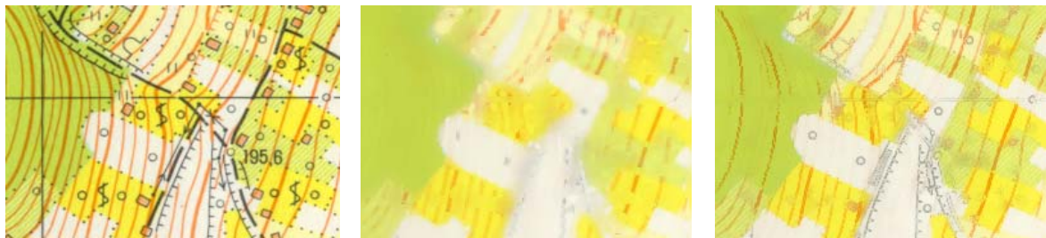
1.58: Eredeti kép. 1.59: Élmegőrző maszkolt mediánszűrővel szűrt változat. 1.60: Sarokmegőrző, adaptív méretű maszkolt mediánszűrővel szűrt változat.
